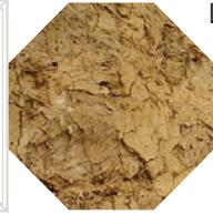
Lehm bindet Wasserdampf in seiner körnigen Struktur sowie im eigentlichen Tonkristall und gleicht damit die Luftfeuchtigkeit im Raum aus.
